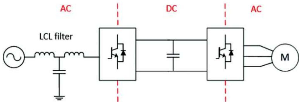
Les variateurs AFE permettent également aux utilisateurs industriels de gagner de la place et de simplifier l'installation. Les filtres passifs peuvent poser des problèmes d'espace dans les locaux électriques et sur la chaîne de production. Leur installation et leur déplacement peuvent également s'avérer difficiles. Les variateurs AFE offrent une filtration intégrée, réduisant ainsi le besoin d'investir dans des dispositifs externes coûteux et encombrants.
